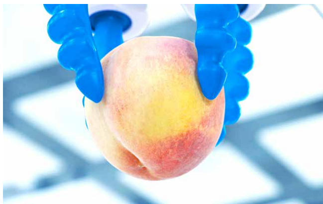
無段階で細かいポジション設定ができ、果物などデリケートなワークも優しく把持
