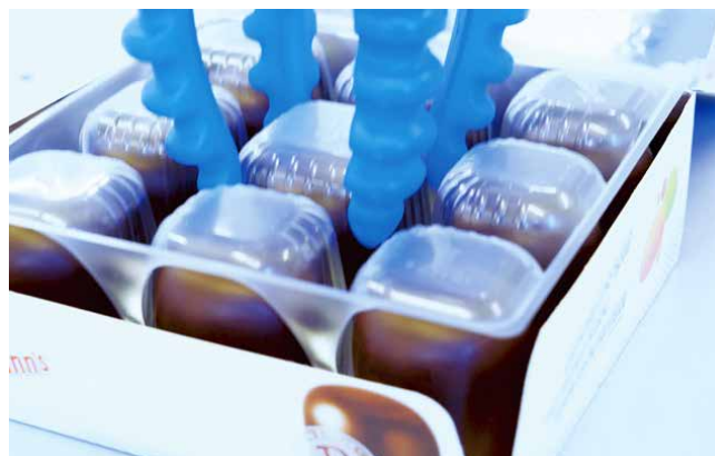
複数の開閉ポジションを保存でき、異なるワークにも段替えなく対応
