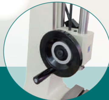
▲左手ハンドルで 主軸の高さを調整
