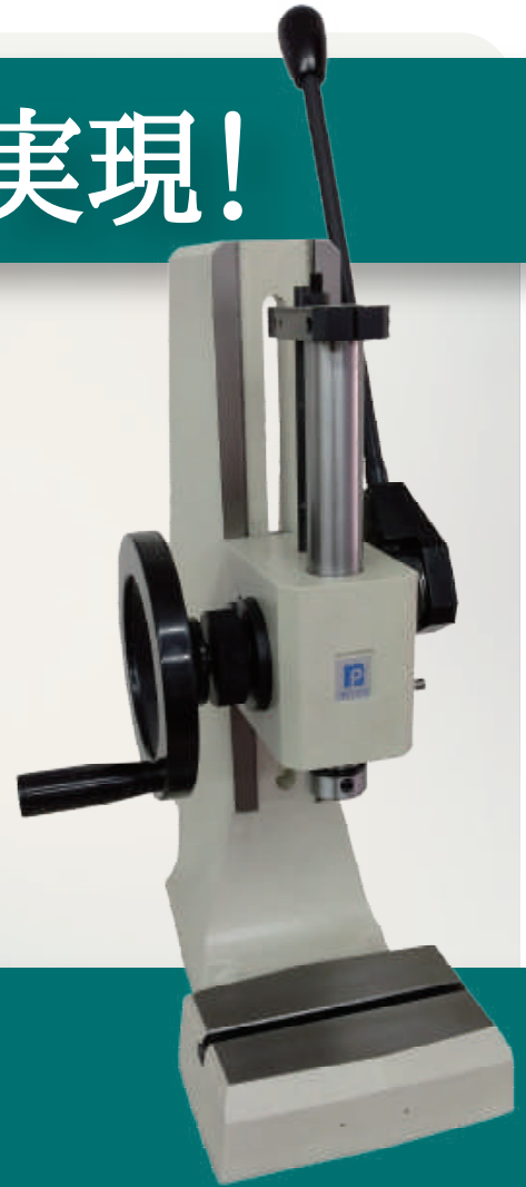
▲左手ハンドルで 主軸の高さを調整
